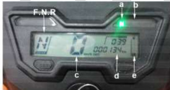
(а) Індикатор нейтральної передачі (б) Індикатор задньої передачі (с) Шпидометр (d) Одометр (е) Показники бензобаку
